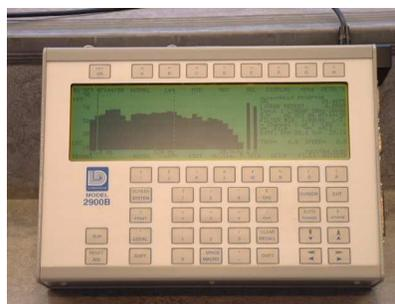
Este Laboratorio se encargó también de las mediciones “ in-situ “ finales; de Tiempos de reverberación, aislaciones acústicas entre distintos locales dentro del Teatro y hacia el exterior, aislaciones antivibratorias de los equipos electromecánicos y de los Niveles de ruido de los distintos locales como las Salas de Máquinas, Sala propiamente dicha y escenario.
