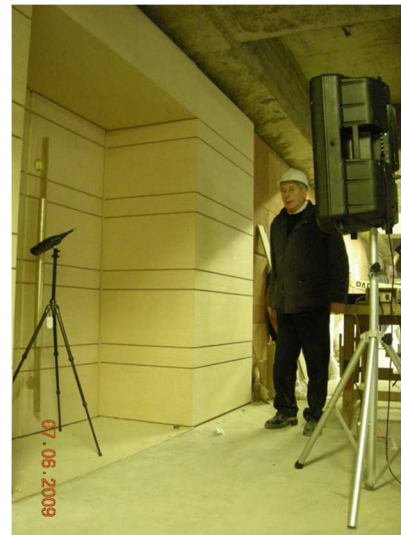
MEDICIÓN DE AISLAMIENTO DE PUERTA DE ACCESO A LA SALA AUDITORIO DEL SODRE
