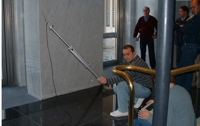
MEDICIÓN DE AISLAMIENTO DE PUERTA EXTERIOR TEATRO SOLÍS
